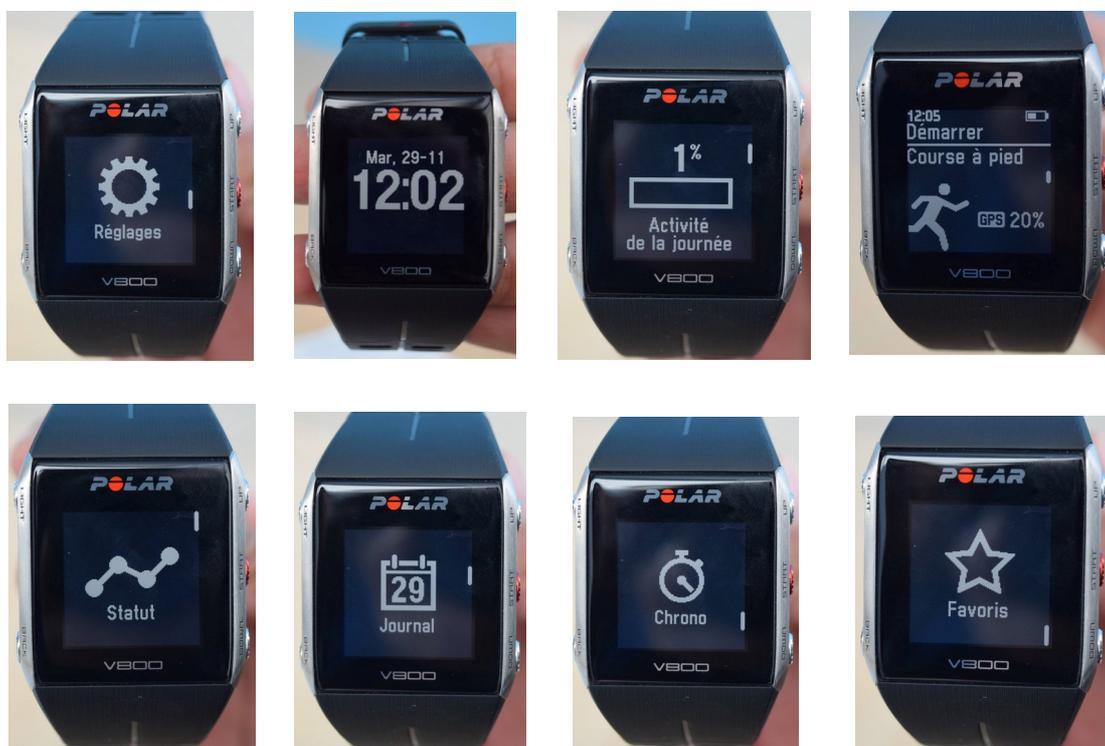
**Déplacer le curseur dans le menu en utilisant les boutons « haut » et « bas », sélectionner un item en appuyant sur le bouton « démarrer ». Pour revenir en arrière, appuyer sur le bouton « retour ».**
